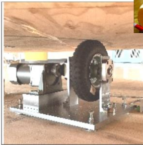
ターンテーブル下の駆動機構
